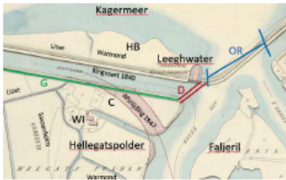
Afbeelding 2. Schetskaart van De Leeghwater en omgeving. 4 Het kaartje geeft de situatie weer van 1843 – 1847. HB = Hellegatpolder buitendijks; OR = Opening Ringdijk (tot 1848); D = overgelaten dam (niet weggegraven oever van de Hellegatpolder; alsnog weggegraven in 1848); G = Grindweg langs de polderkade; C = huidige (!) camping Hof van Eeden; WI = woning van Van Immerzeel (nr. 151).
